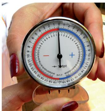
Figura 6-11A. Esferometría Central
