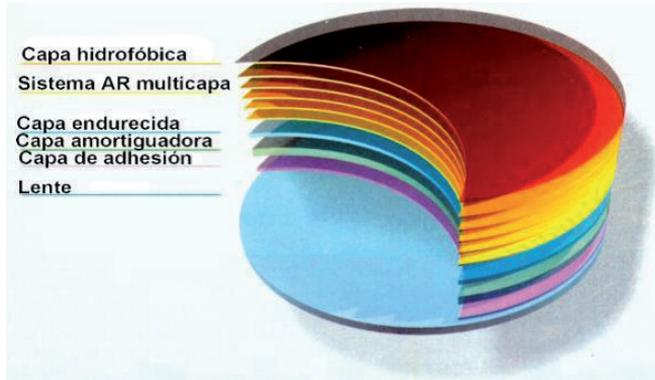
Figura 4-22. Multicapas (Interferencia)
