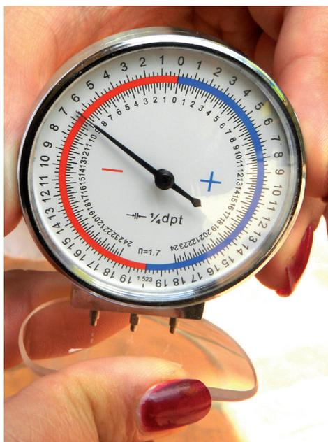
Figura 6-10. Esferómetro
