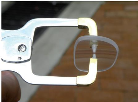
Figura 6-13. Espesimetría Central
