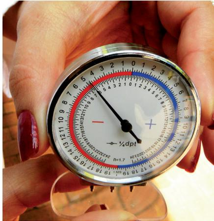
Figura 3-1. Esferómetro actualizado para índice Alto
